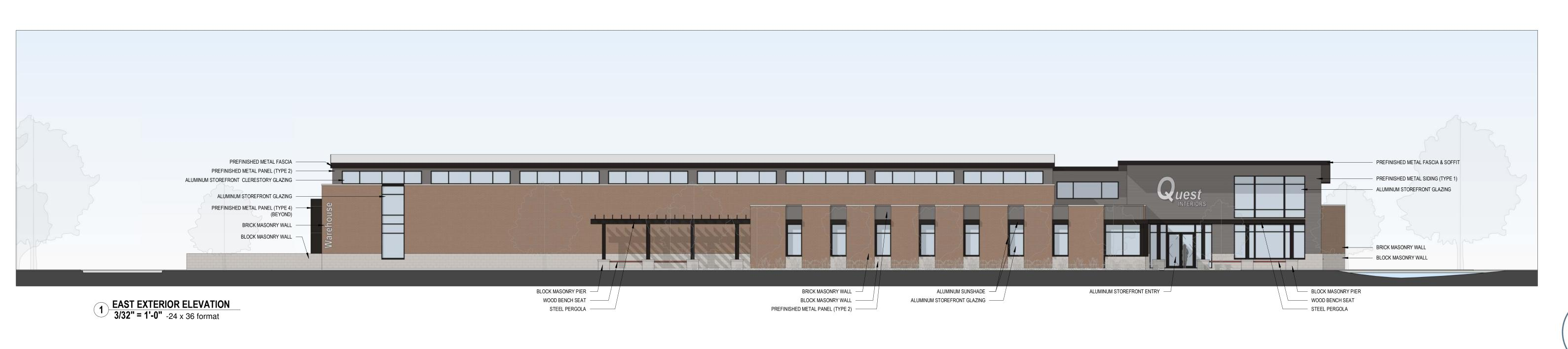
PREFINISHED METAL FASCIA & SOFFIT PREFINISHED METAL FASCIA PREFINISHED METAL SIDING (TYPE 1) PREFINISHED METAL PANEL (TYPE 2) ALUMINUM STOREFRONT GLAZING PREFINISHED METAL PANEL CANOPY (TYPE 4) (BEYOND) Ш PREFINISHED METAL PANEL (TYPE 2) PREFINISHED METAL SIDING (TYPE 1) ALUMINUM SUNSHADE ALUMINUM STOREFRONT GLAZING BLOCK MASONRY WALL BLOCK MASONRY WALL — BLOCK MASONRY WALL BLOCK MASONRY WALL NORTH EXTERIOR ELEVATION
