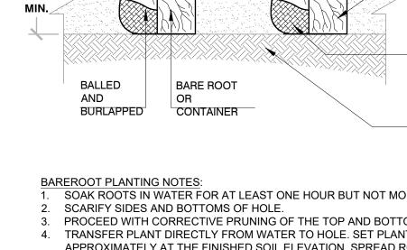
IMMEDIATELY BACKFILL WITH PLANTING SOIL MIX.
